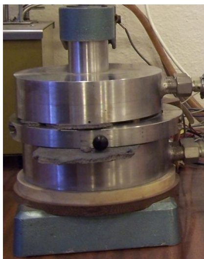
Rys. 3 Próbki umieszczone w głowicy pomiarowej lambdomierza.
