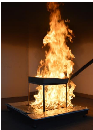
Rys. 1. Badania pianki poliuretanowej K4036 metodą wg PN-EN 45545-2:2013, Aneks B (fot. własna)
