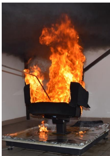
Rys. 3. Badania fotela F4 metodą wg PN-EN 45545-2:2013, Aneks B (fot. własna)
