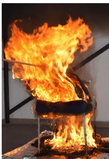
Rys. 2. Badania fotela F1 metodą wg PN-EN 45545-2:2013, Aneks B (fot. własna)
